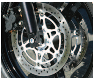
Wirksam und gut dosierbar zeigt sich die 310 mm-Doppelscheibenbremse vorne.
