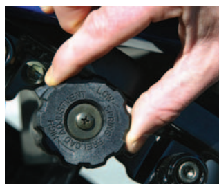
Jetzt auch bei Suzuki: Hydraulische Einstellung der Feder-Vorspannung.
