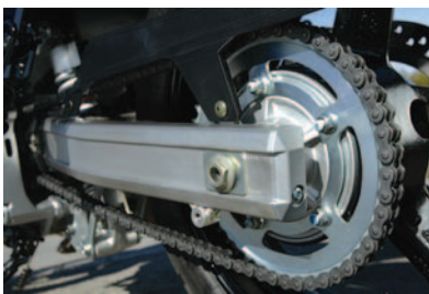
Eine O-Ring-Kette stellt den kostengünstigen Antrieb des Hinterrades dar.
